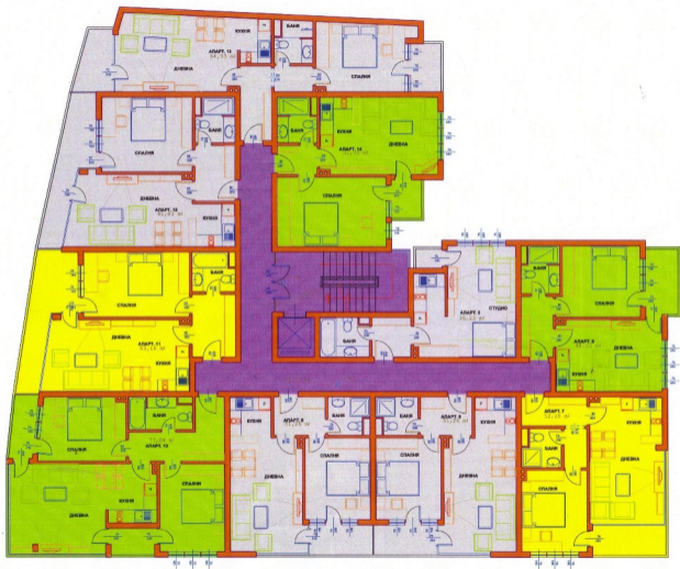
РАЗПРЕДЕЛЕНИЕ И ТЕХНОЛОГИЧНО ОБЛАВЕЖДАНЕ НА ПЪРВИ ЖИЛИЩЕН ЕТАЖ М 1:100
