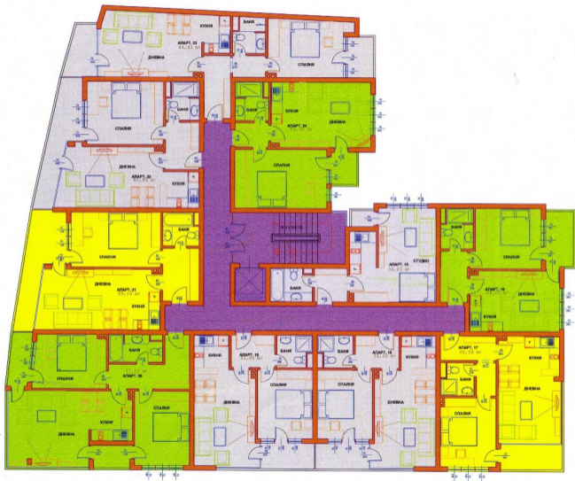
РАЗПРЕДЕЛЕНИЕ И ТЕХНОЛОГИЧНО ОБЗАВЕЖДАНЕ НА ВТОРИ ЖИЛИЩЕН ЕТАЖ М 1:100
